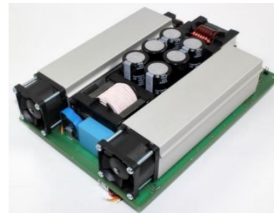
Ladegerät und Antriebs-Wechselrichter im E-Fahrzeug
