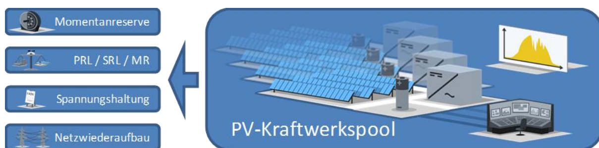
Abbildung 10: Systemdienstleistungs-Optionen für einen PV-Kraftwerkspool
