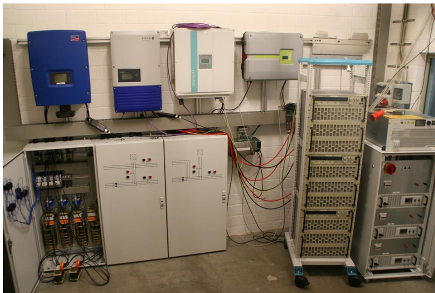
Abbildung 21: Versuchsaufbau im Netzintegrationslabor zur Stabilität der Q(U) Regelung
