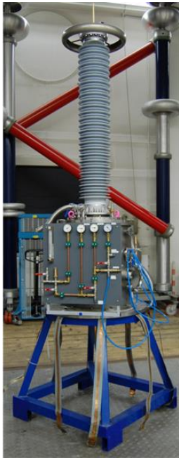
Abbildung 37: Kryostat mit Durchführung Figure 37: Cryostat with bushing
