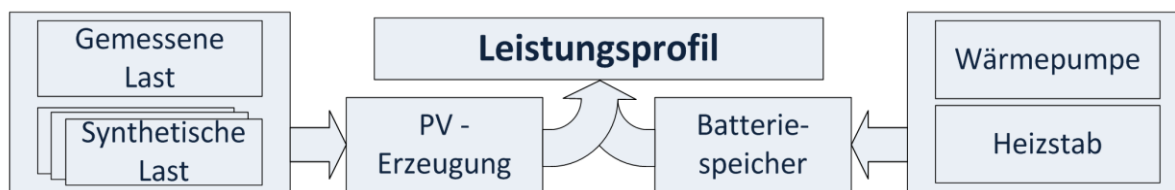
Abbildung 18: Schematische Erzeugung von Leistungsprofilen
