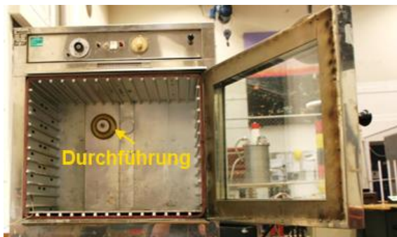
Abbildung 36: Wärmeofen mit Durchführung Figure 36: Temperature-oven with bushing
