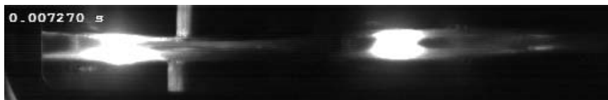
Abbildung 3: Lichtbogen zwischen TMF-Kontakten
