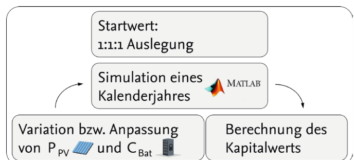
Iterativer Prozess zur Ermittlung eines wirtschaftlichen Optimums für PV-Anlage und Speicher
