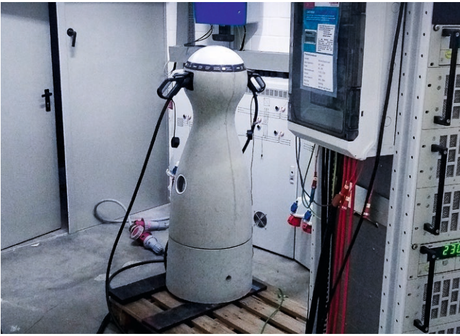
Ladesäule der PION AG im 7-stündigen 44kW-Dauerbelastungstest
