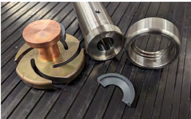
Fertigung eines Adapters aus VA zur Aufnahme von Kupfer-Schaltkontakten
