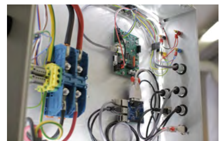
Abbildung 1: Kommunikationsinfrastruktur für eine Labor-DC-Ladesäule, Foto: TU Braunschweig, Henrik Herr
