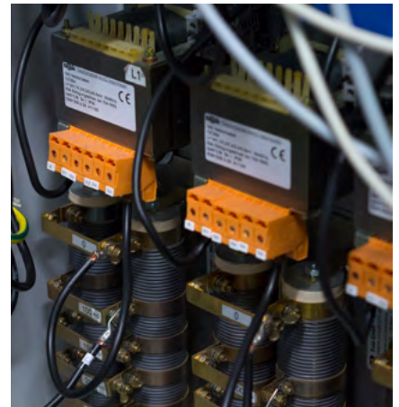
Abbildung 5: Leitungsnachbildende Elemente entsprechen bis zu 1,8 km Niederspannungskabel
