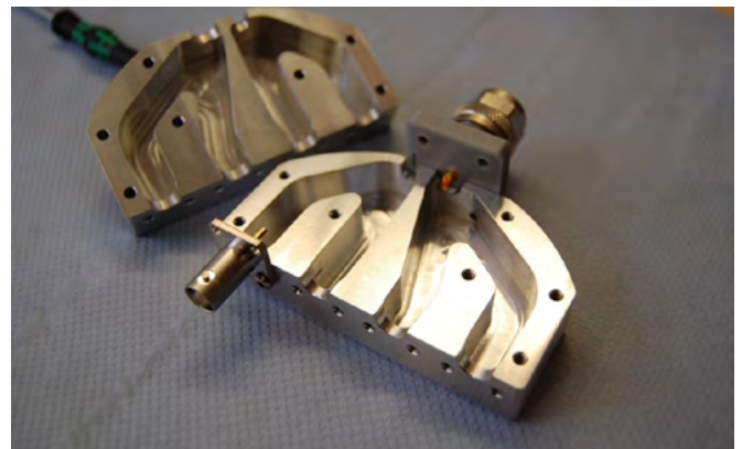
CNC gefrästes Gehäuse für einen Messadapter
