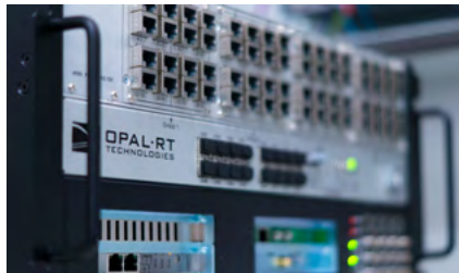
Abbildung 3: Rechenstarker OPAL Echtzeitsimulator mit analogen Schnittstellen zur Ansteuerung von Komponenten im Labor
