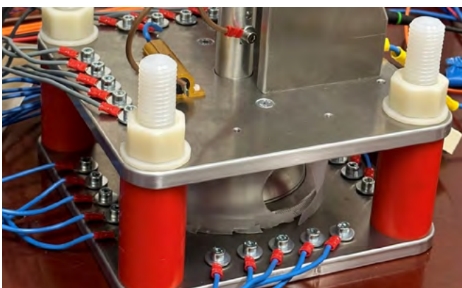
Fertigung einer Schaltgerätenachbildung
