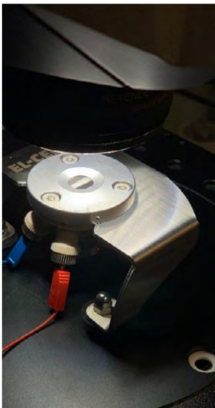
Abbildung 2: Optische Batteriezeile zur in-Operando-Diagnose von Elektroden während der Formierung
