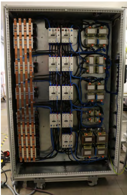
Abbildung 2: Innenansicht der neuen Netznachbildung – Autor: M. Gand
