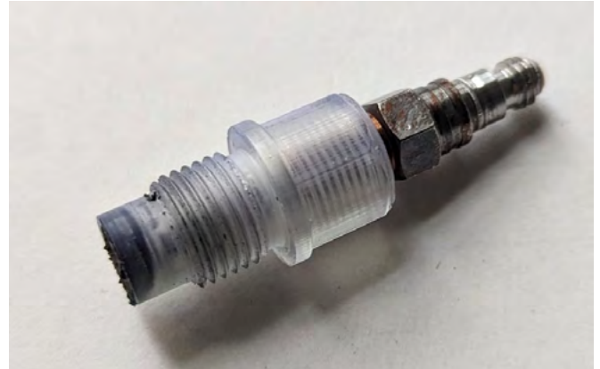
SLA 3D-Druck eines Adapters zur Montage von Drucksensoren
