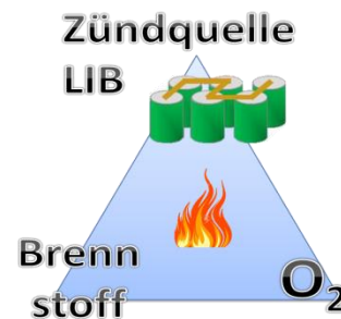
Abbildung 10: LIB als Zündquelle im Explosionsdreieck Figure 10: LIB as ignition source in the explosion triangle
