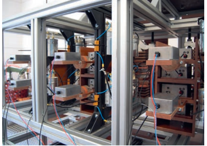
→ Spiegelhalterung für experimentelle Untersuchung langer Schaltlichtbögen (Projekt: EUlaS)
