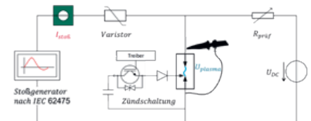
Abbildung 1: Prüfkreis zur Untersuchung des Netzfolgestromverhaltens von Funkenstrecken
