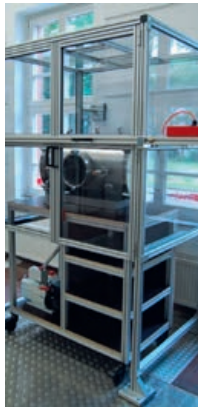
↓ Funkenstreckenhalterung: Sicherheitseinrichtung für unsere Kondensatorbank, die im Weil- Dobke Prüfkreis eingesetzt wird.
