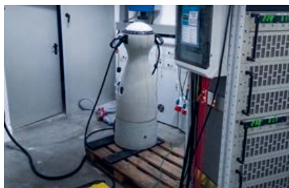
Abbildung 1: Ladesäule der PION AG im 7-stündigen 44kW-Dauerbelastungstest
