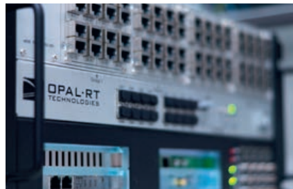
Abbildung 4: Rechenstarker OPAL Echtzeitsimulator mit analogen Schnittstellen zur Ansteuerung von Komponenten im Labor
