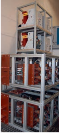
→ Mechanische Befestigung der Treiberbeschaltung einer B12 Brücke
