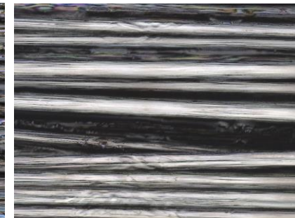
Freigelegte Fasern durch Laser
