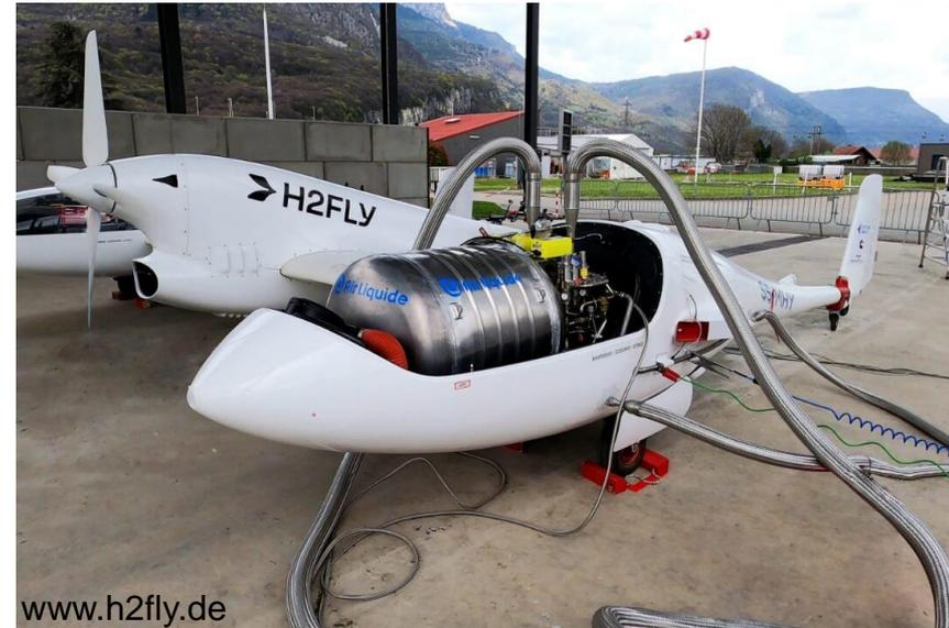
Abb. 1: Flüssigwasserstoff für die Luftfahrt: Flugzeug HY4 der Fa. H2FLY
