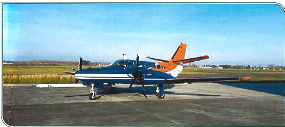
Das neue Forschungsflugzeug (D-ILAB) mit Nasenmast und 5-Blatt-Propeller
