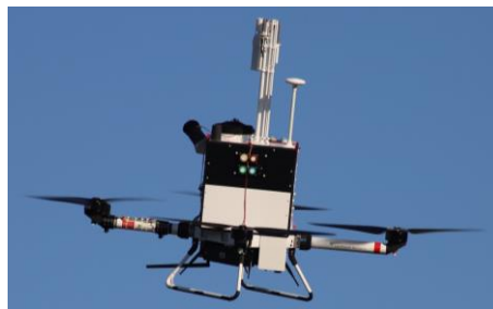
Abb. 9: Quadrocopter MesSBAR der TU Braunschweig zur Schadstoffmessung
