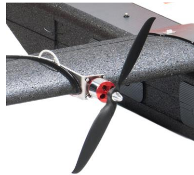
Abb. 4: Elektrisch angetriebene Propeller des DLR Explorer
