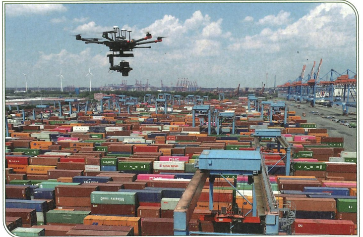
Das Fluggerät der TU Braunschweig bei der Vermessung von Kranschienen im Hamburger Hafen.
