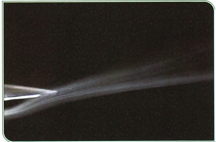
Visualisierung der Strömungsumlenkung an der Hinterkante eines Windkanalmodells mit aktiver Ausblasung zur Böenlastreduktion. Foto: Institut für Strömungsmechanik/TU Braunschweig
