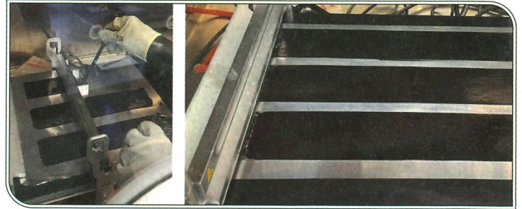
Herstellung von Elektrodenschichten (Kathode mit Elektrolyt) für Lithium-Schwefel-Festkörperbatterien
