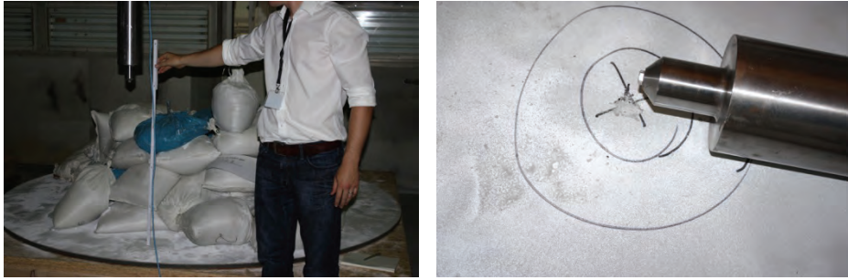
Bild 5-1 Torpedofallversuch bei einer Umgebungstemperatur von 40 °C © seele_sedak
