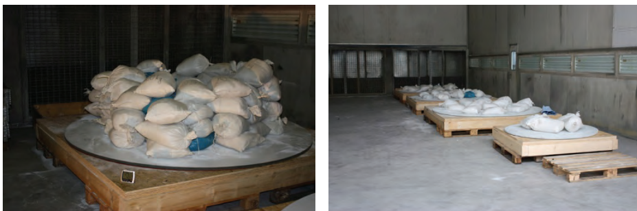
Bild 5-2 Reststandversuch bei einer Umgebungstemperatur von 40 °C / 25 °C © seele_sedak
