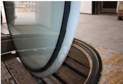
Bild 2-4 Versuchskörper für die Begutachtung des Resttragverhaltens © seele_sedak
