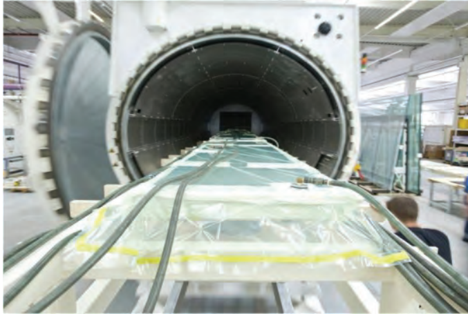
Bild 4-1 Glasscheiben im Foliensack beim Einbringen in den Autoklaven © seele_sedak
